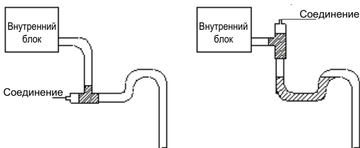
№1: 3-ходовое соединение дренажной трубки
